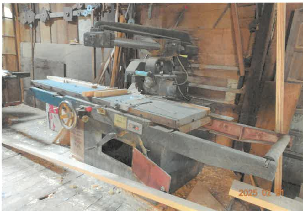
②⑥ (工場機械目録番号17 ほぞ取機)
